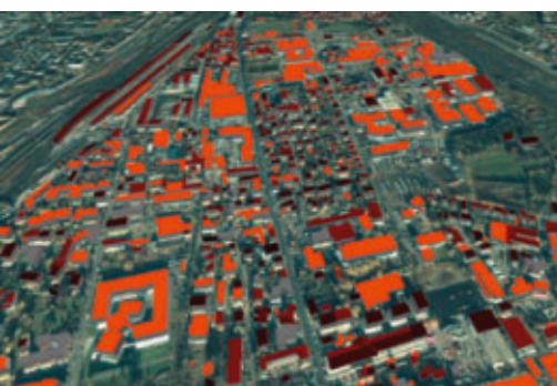
3D-Modell Schallmoos zur Ermittlung von Kubatur und Dachform
