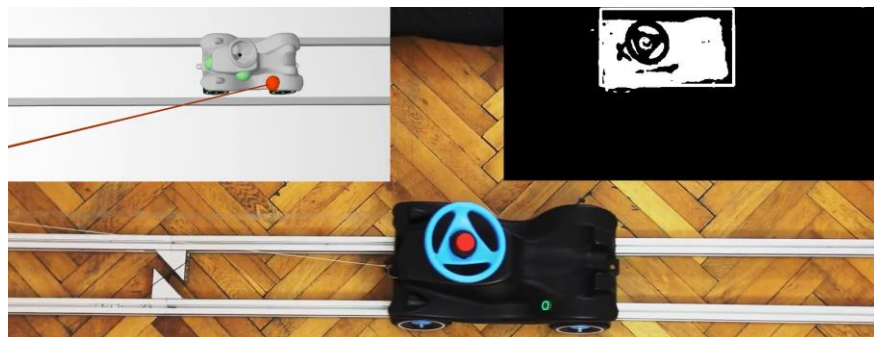
Abb. 3: Aufprojektion des Lasers im virtuellen Modell (links oben), Erfassung der Position des Dummy-Fahrzeugs im Kamerabild (rechts oben), und tatsächliche Aufprojektion des Lasers unten, (grüner Kreis)
